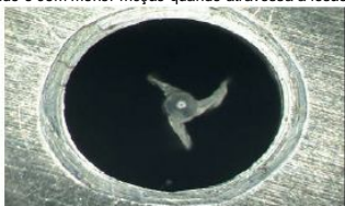
Corte Transversal do Balão
